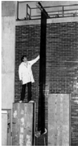
Figura II.5. Del lado izquierdo la banda transportadora de carga eléctrica. Del lado derecho la polea inferior acoplada al motor impulsor de la banda y los electrodos de inducción de carga.
