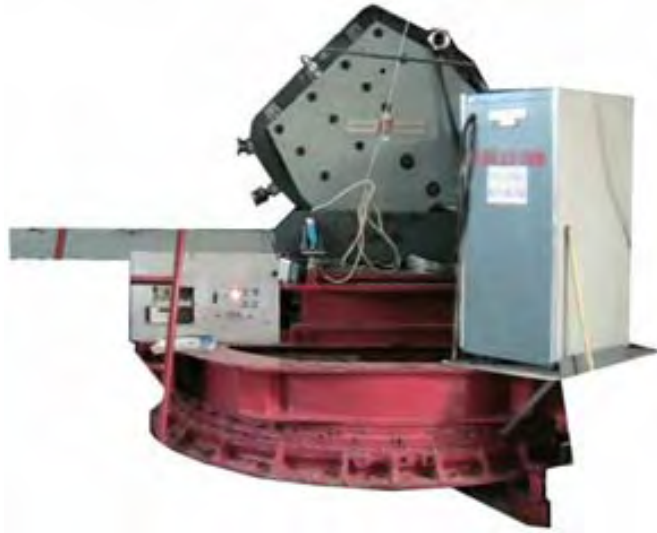
Figura II.13. Imán selector de energía de 90° junto con su fuente de voltaje, montados sobre la base giratoria.
