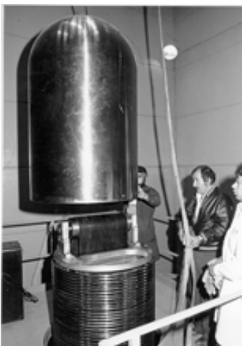
Figura II.6. Del lado izquierdo se muestra la parte superior de la columna, el plato superior, la polea superior, la banda tensa y el domo metálico. Del lado derecho se muestra una de las 12 secciones de la columna.
