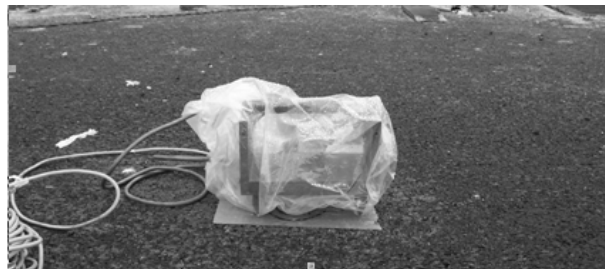
Fig. 10 Acelerómetros en base metálica
