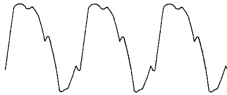
Corriente demandada por una lámpara fluorescente
