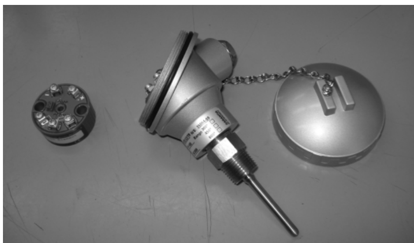
Figura 3.11. RTD pt-100 y cabeza transmisora Mp82800-R.
