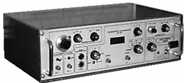
Figura 30. Potencióstato VIMAR empleado
