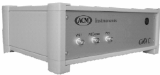
Figura 29. Potencióstato Gill AC empleado
