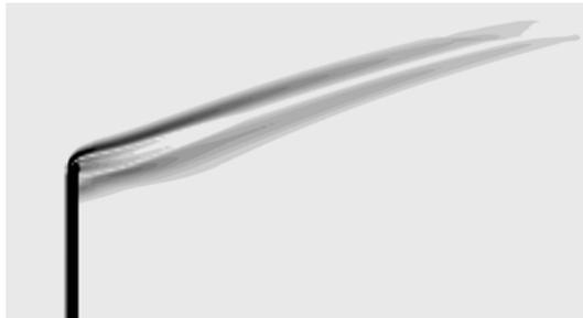
Figura 2.1: Visualización de una llama mediante su sombra
