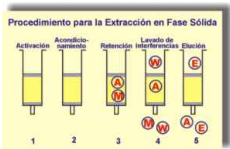
Figura 13: Pasos para la activación del cartucho de EFS o SEP
