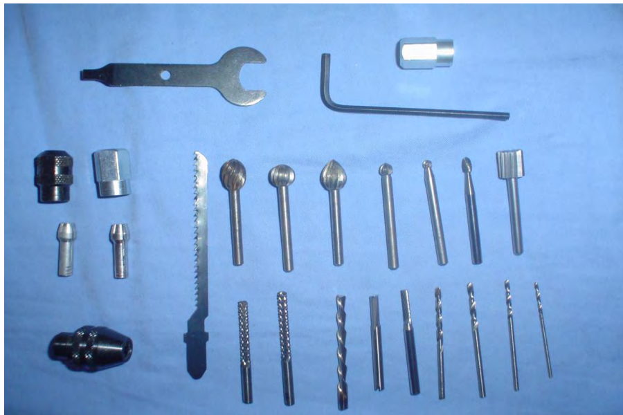
Fig 10. Kit de utensilios para el manejo con el aparato, brocas cortadoras (abajo), brocas fresadoras (arriba) y resto de adaptadores para uso de las brocas.
