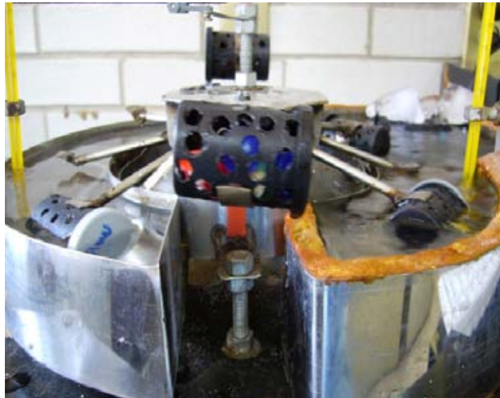
Figura 29. Termociclado de las muestras
