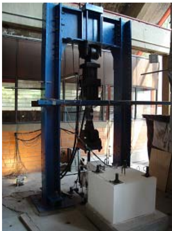
Figura 3.8. Marco de carga y espécimen sujeto a la losa de reacción durante el proceso de ensaye
