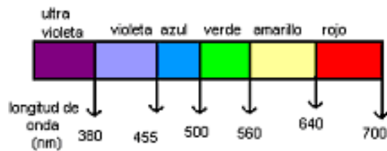
Fig. 14. Esquema que representa las regiones del espectro en la zona de la luz visible con la respectiva longitud de onda para cada color (Iturrate, 1998).
