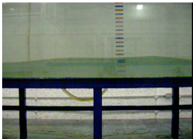
Figura 5.9: Superficie libre a la mitad de la interacción (perfil de meseta con dos crestas) a 15 m del pistón.
