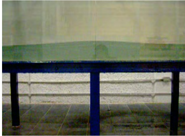
Figura 5.6: Perfil de la onda menor antes del cruce. A_1 = 3.26\text{cm} , X_{S1} = 6.68\text{m} .
