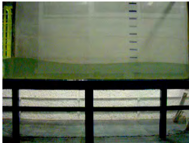
Figura 5.11: Superficie libre a 23 m del pistón: separación de las ondas solitarias.
