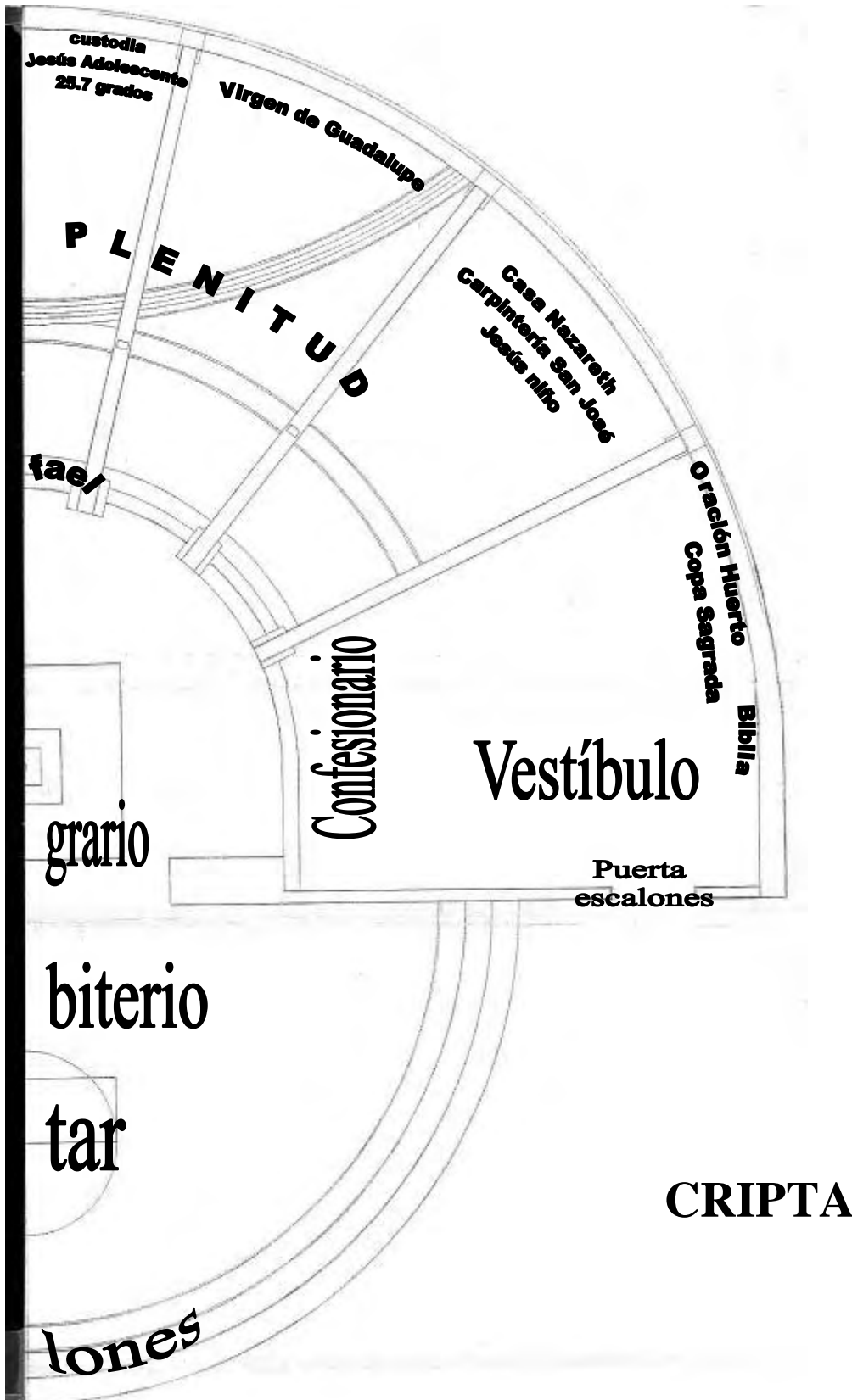
Planta: área sagrada, conjunto integrado, semicírculo capilla Plenitud, sacristía, vestíbulo confesionario, 10 m radio, semicírculo presbiterio, 6.18 m radio áureos, sagrario en el centro y rectángulo altar.
