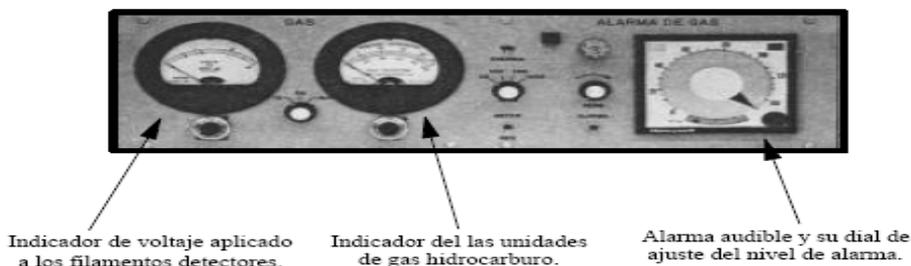
Para reactivar el filamento, subir el voltaje del voltímetro a toda su capacidad y dejarlo con ese voltaje durante unos 15 minutos para que desprenda todas las partículas adheridas. Después de esta operación regresar a los voltajes de trabajo y verificar si las lecturas son normales usando un encendedor de gas. Si al ponerle gas al filamento la lectura sube a unas 40 unidades con un paso rápido, el filamento está en buenas condiciones de operación.
