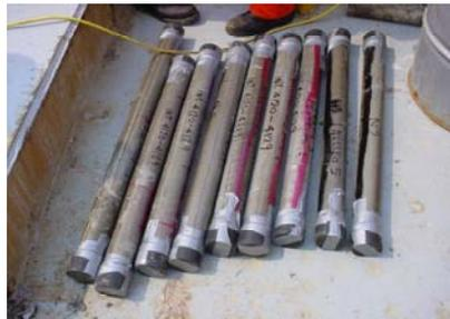
Núcleo empaquetado y marcado
