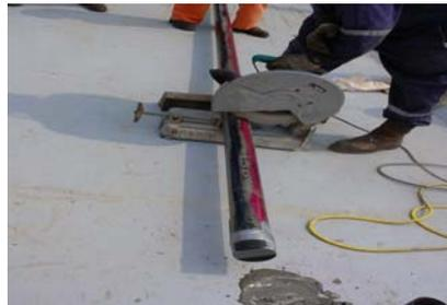
Cortando el núcleo en secciones
