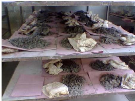
Muestras en proceso de secado en laboratorio
