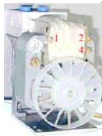
Bomba para succionar el gas de cortes o gas de fondo.
