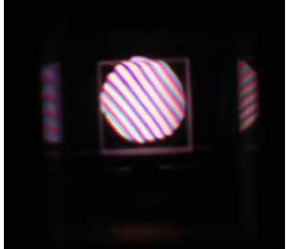
Figura 2.7. Fotografía de una de las salidas del IMZ usando a la lámpara fluorescente como fuente de luz.
