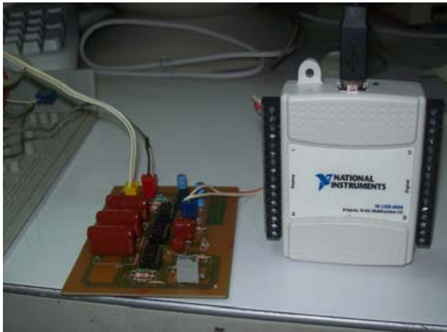
Figura 5.10 Tarjeta de National Instruments utilizada como interfaz para la digitalización de la señal.
