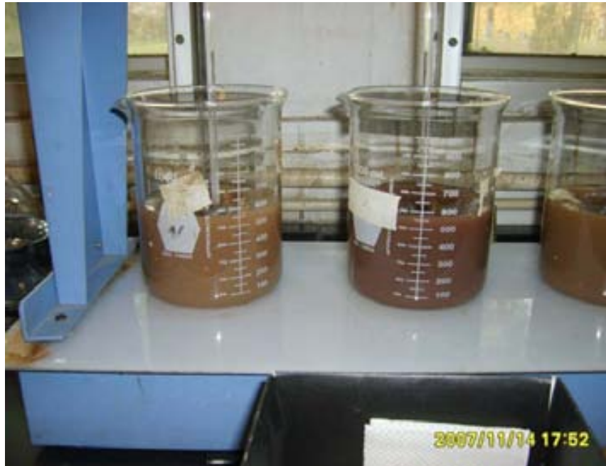
Figura 4.4 Mezcla rápida de las aguas congénitas al aplicar ferrato de potasio.
