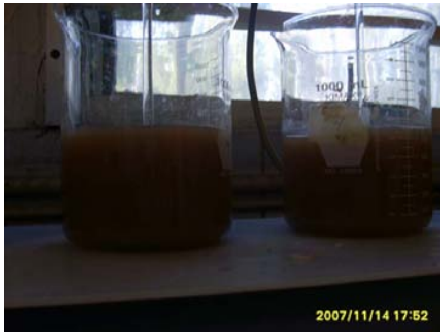
Figura 4.5 Color de las aguas congénitas al aplicar ferrato de potasio.
