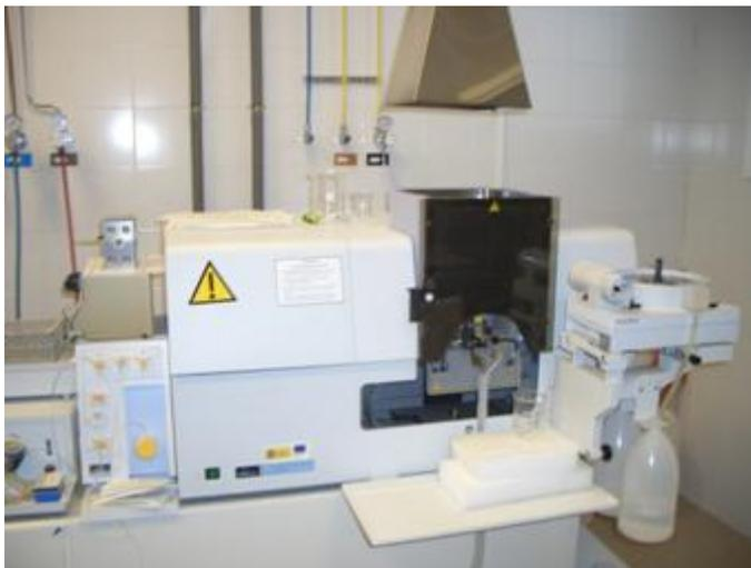
Figura 2.9. Espectrofotómetro de absorción atómica<sup>39</sup>
