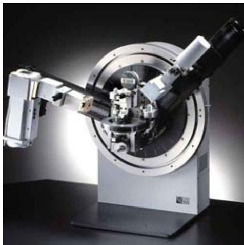
Figura 2.5. Goniómetro para difracción de rayos X.<sup>33</sup>
