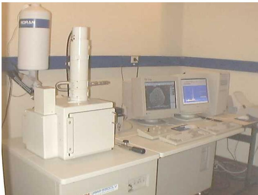
Figura 2.11. Microscopio electrónico de barrido.<sup>43</sup>
