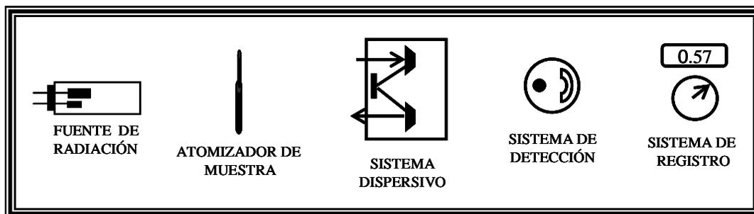
Figura 2.8. Diagrama de instrumentación. Absorción atómica
