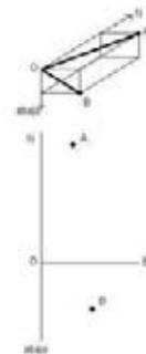
**Figura 14.** Construcción del Diagrama de Zijderveld. A y B cabezas de vector de magnetización (mod. Butler, 1992).
