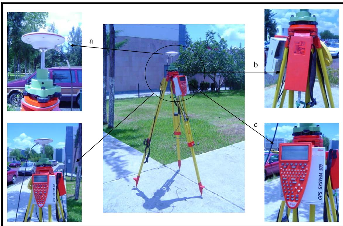
**Fig. IV.5.2.** Elementos del sistema GPS 500; a). Antena microstrip L1/L2 AT502; b). Batería externa; c). Receptor GPS RS500 y terminal GPS TR500.
