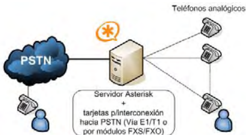
Figura 3.1: Asterisk como un PBX tradicional
