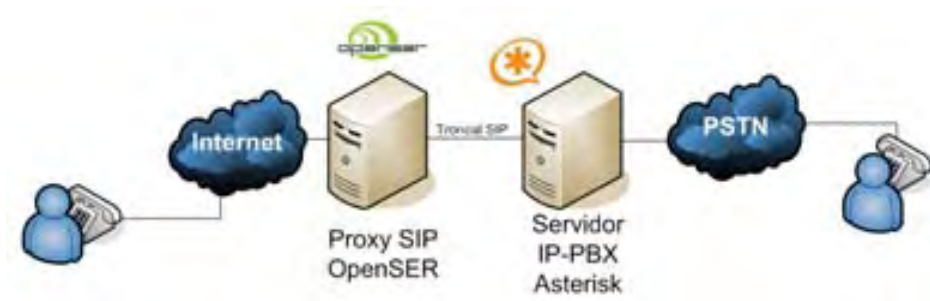
Figura 4.8: Integración de Asterisk y OpenSER
