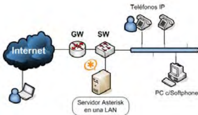
Figura 3.2: Asterisk como un IP-PBX
