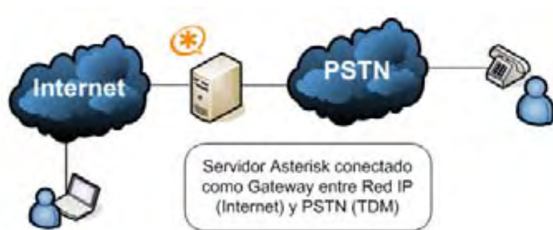
Figura 3.4: Asterisk como gateway PSTN/VoIP
