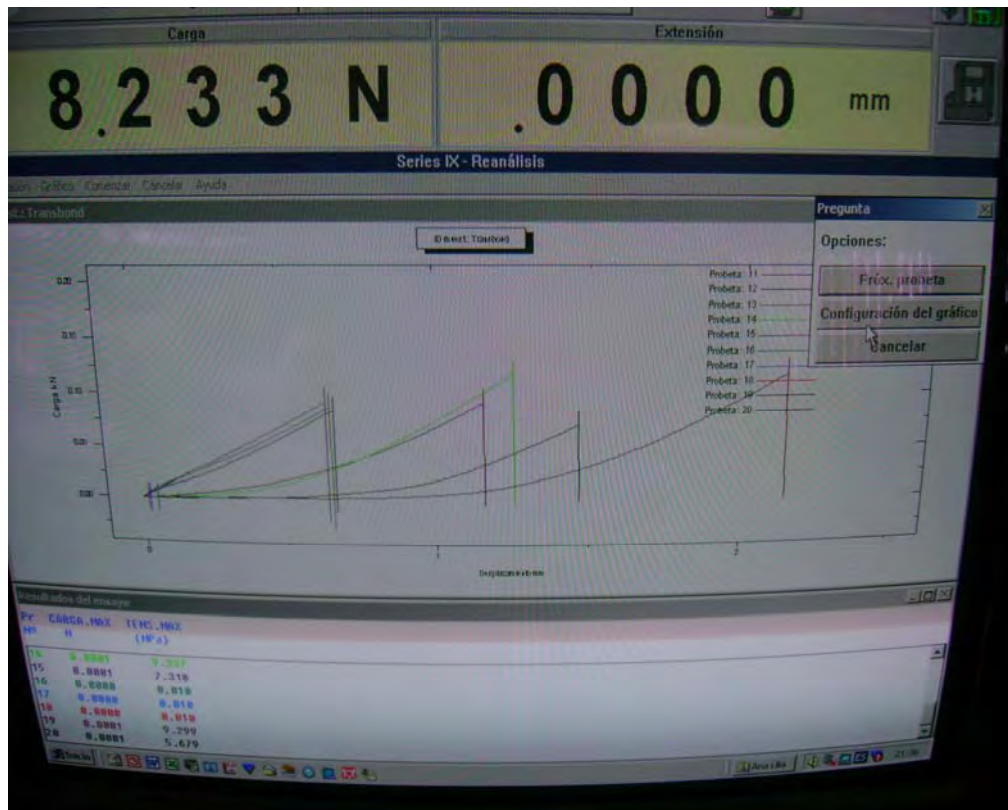
Figura 17. Fotografía de la pantalla que muestra la graficación de la máquina Instron modelo 5567, durante la prueba de desprendimiento.
