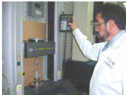
Figura 15. Manejo para la prueba de desprendimiento en la máquina Instron por uno de los expertos.
