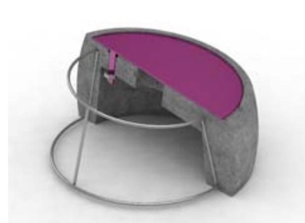
Base de concreto con armado de varilla
