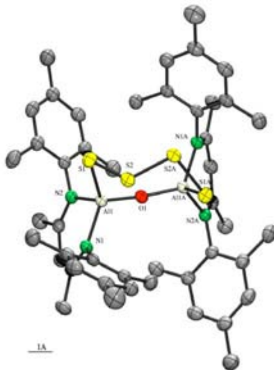
Figura 25: Estructura molecular de [Al(\mu-O)\{\mu-(S_4)\}Al] ( 3a ).
