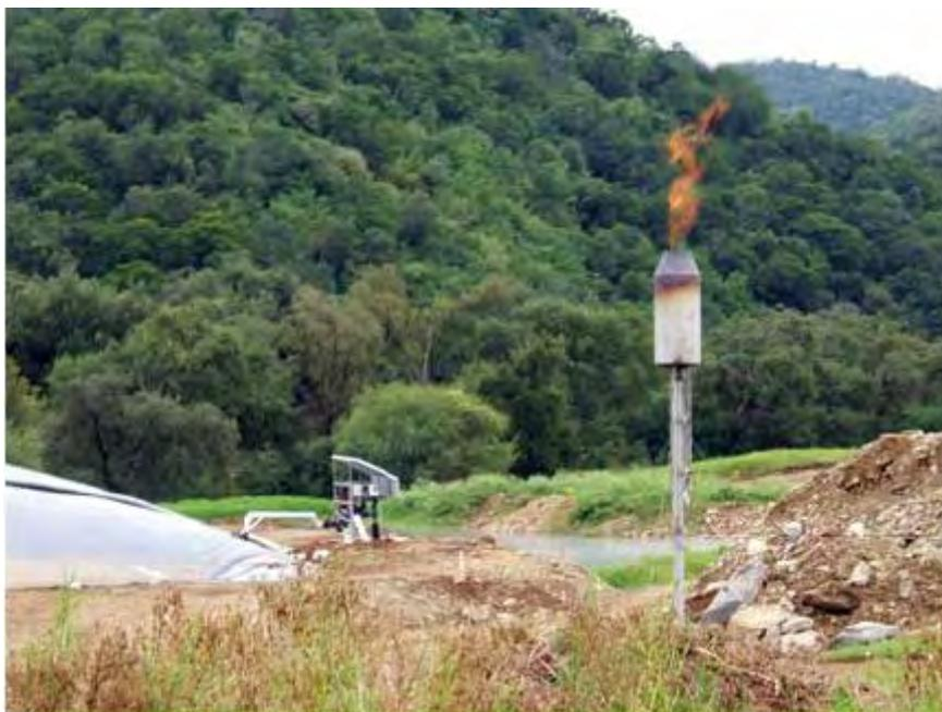
**FIGURA 3.13** *Quemador de biogás.*
