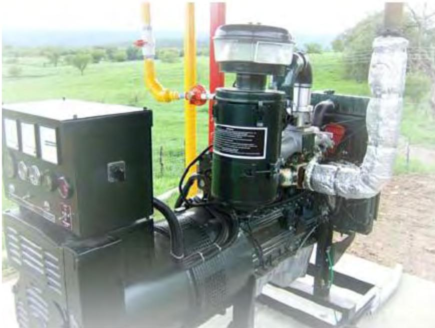
**FIGURA 2.5** *Motogenerador Eléctrico Alimentado Con Biogás. FUENTE: Revista Claridades Agropecuarias # 168.*
