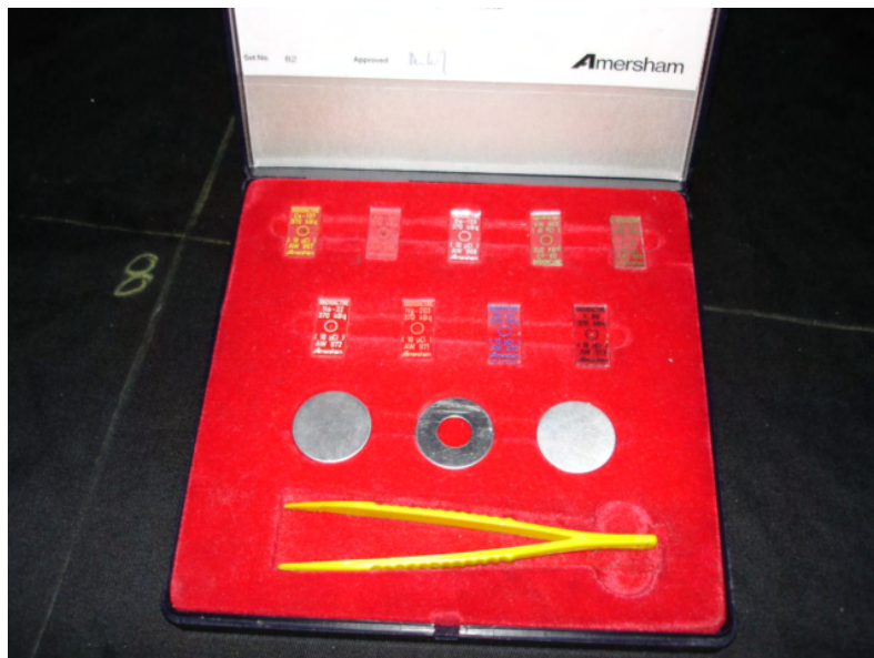
Figura 4.15 Estuche de fuentes radioactivas
