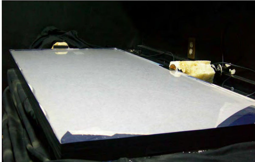
Figura 4.8 Fotografía del dispositivo experimental para observar el comportamiento a la posición de una fuente de gamas con dos fotomultiplicadores
