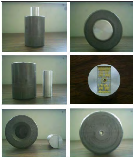
Figura 4.17 Fotografías del blindaje-colimador. (De izquierda a derecha) a) Vista lateral del blindaje con el cilindro que soporta la fuente dentro de él. b) Vista frontal delantera del blindaje. c) Blindaje y el cilindro de aluminio por separado. d) Muesca del cilindro de aluminio que sostiene la fuente radioactiva. e) Vista del agujero donde se inserta el cilindro de aluminio. f) Agujero colimador.
