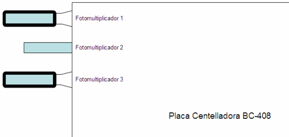
Figura 4.21 Dispositivo experimental para determinar la influencia de las guías de luz y el blindaje magnético en los espectros obtenidos de la placa centelladora.
