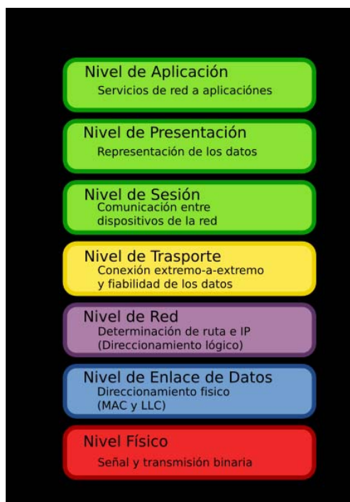
Figura 11. Esquema general del Modelo OSI.
