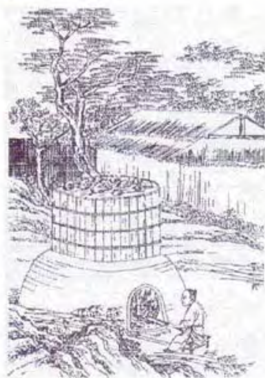
"Se cuecen al fuego las fibras interiores de los tallos"
