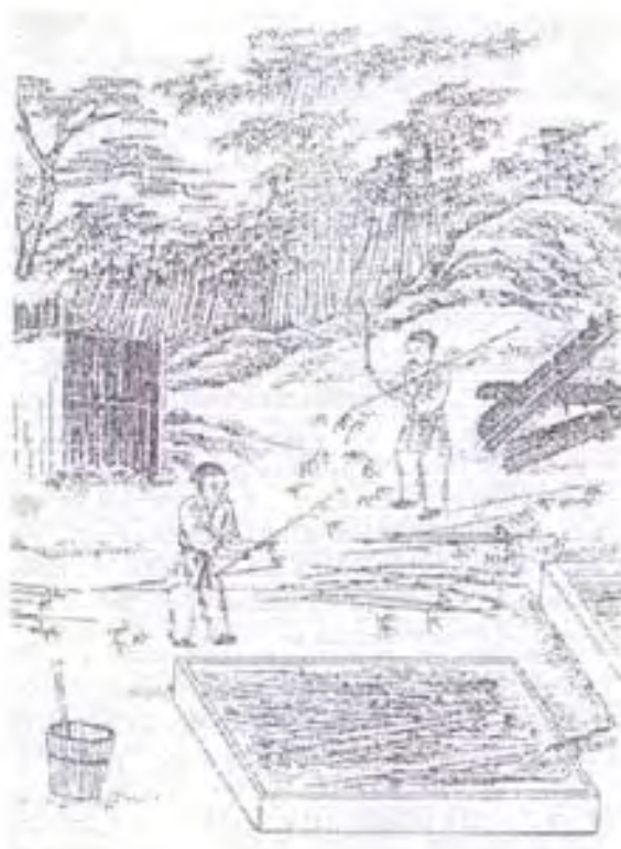
"Se remojan en agua los tallos del bambú."
