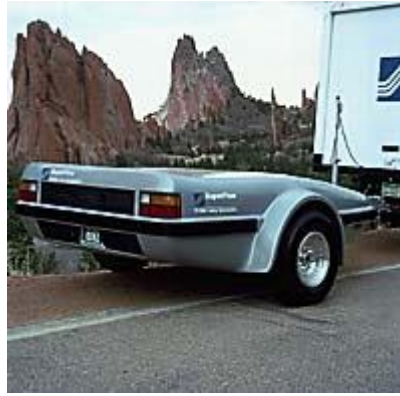
Figura II.7. Aspecto de un dinamómetro de remolque.
