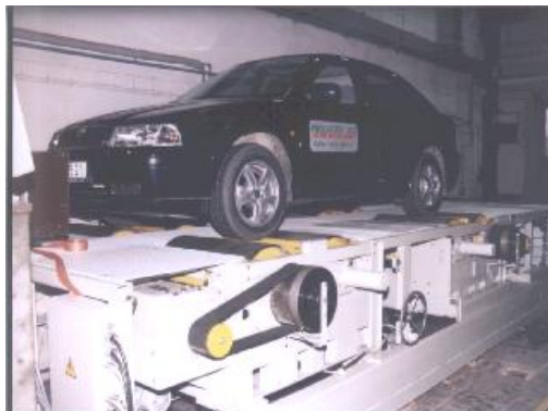
Figura II.5. Dinamómetro de chasis en fábricas de automóviles.
