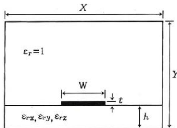
Figura 5.8. Línea de transmisión del tipo microstrip
