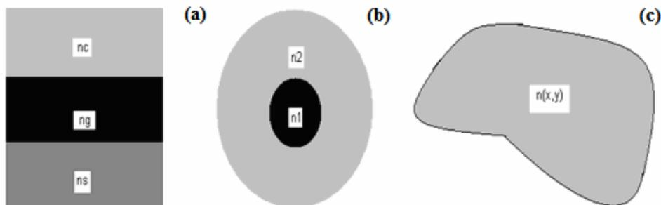
**Figura 2.2 Clasificación de guías de onda**
