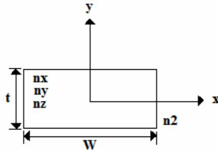
**Figura 5.5. Guía de onda enterrada**
