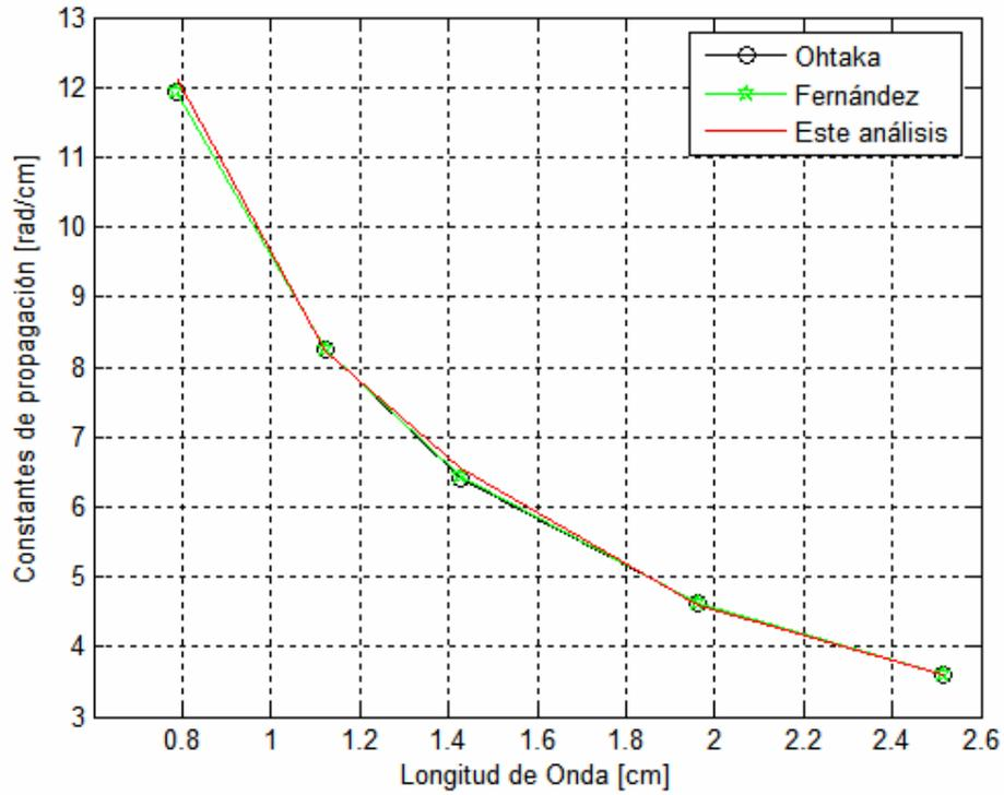
**Figura 5.6. Dispersión del modo Ex11 en una guía de onda enterrada**
