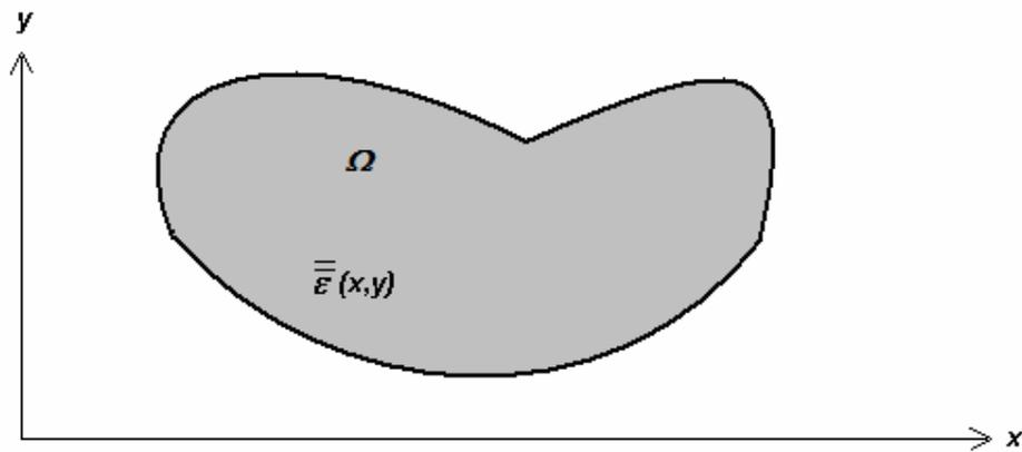
Figura 3.1 Estructura general de una guía de onda dieléctrica. La frontera puede estar formada por paredes perfectas magnéticas y eléctricas y secciones extendiéndose al infinito
