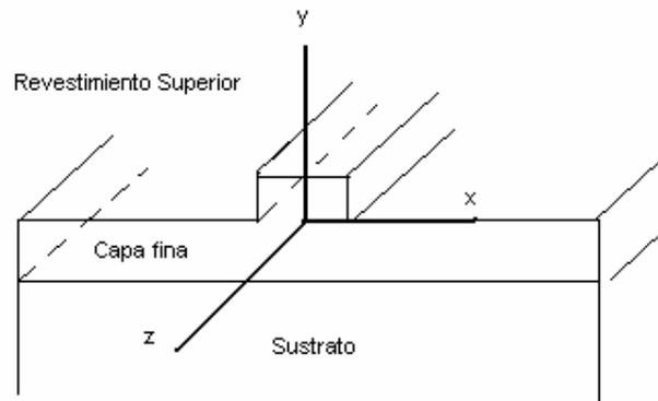
Figura 1.2 Guía de onda óptica
