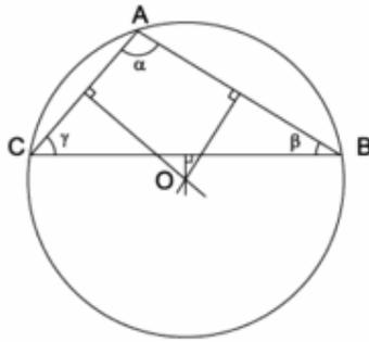
**Figura 4.5. Los tres vértices A, B, C del triángulo ABC están a la misma distancia del circuncentro O.**
