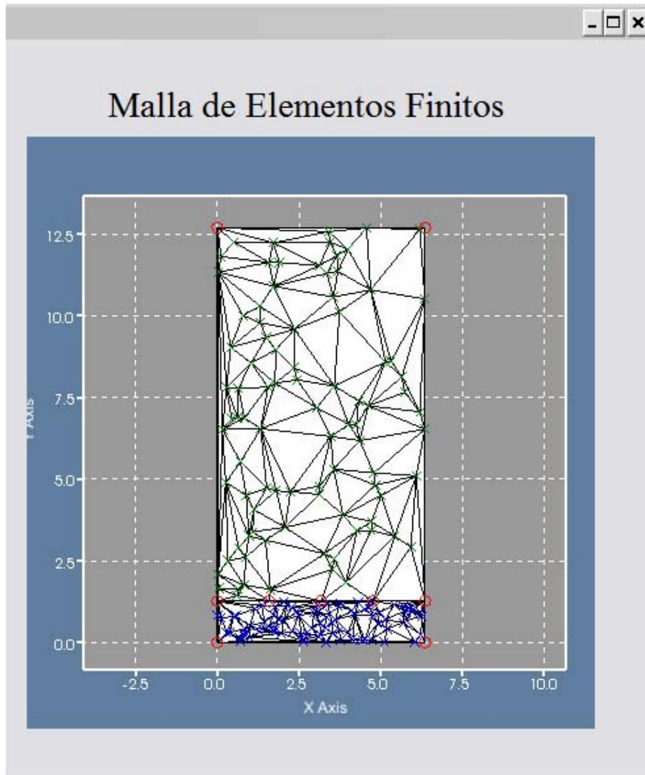
**Figura 5.10. Malla de elementos finitos línea de transmisión microstrip**
