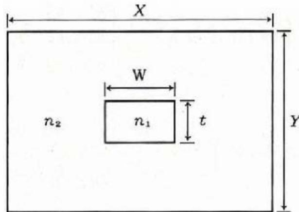
**Figura 5.1. Guía de Onda Rectangular dieléctrica**
