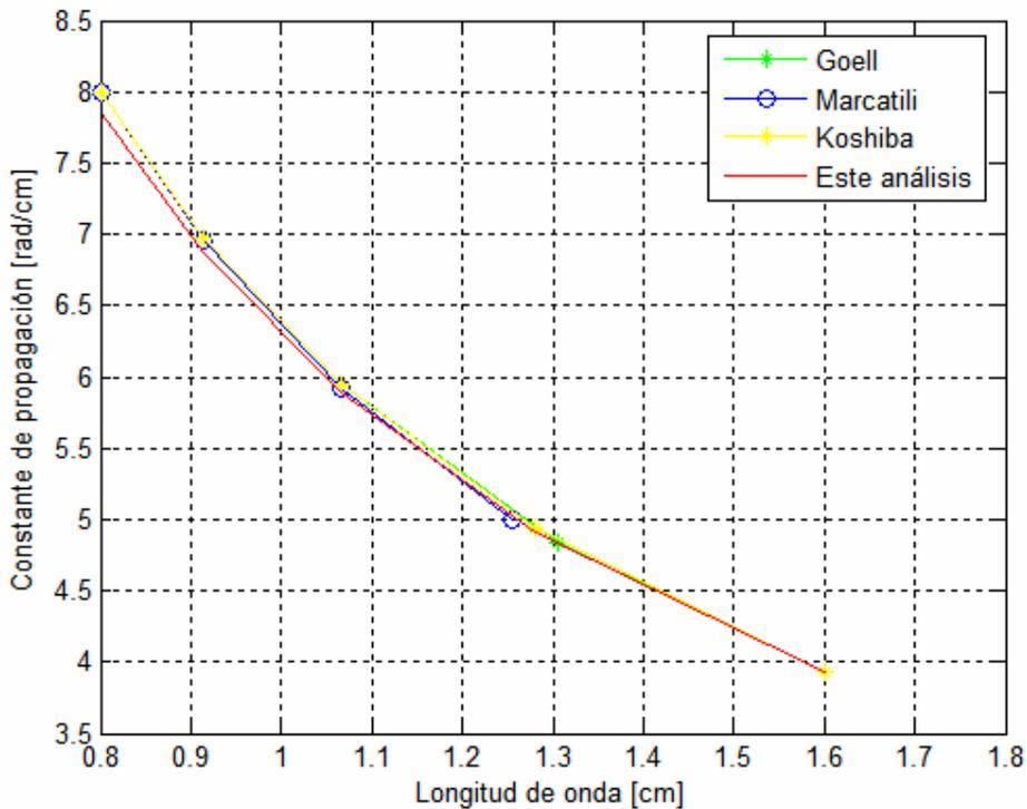
**Figura 5.4 Características de propagación de una guía de onda rectangular. Modo Ex11 ( $n_1 = 1.05$ ,  $n_2 = 1.0$ ).**
