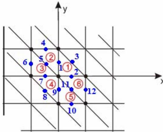
**Fig. 4.7. Numeración de elementos y nodos**
