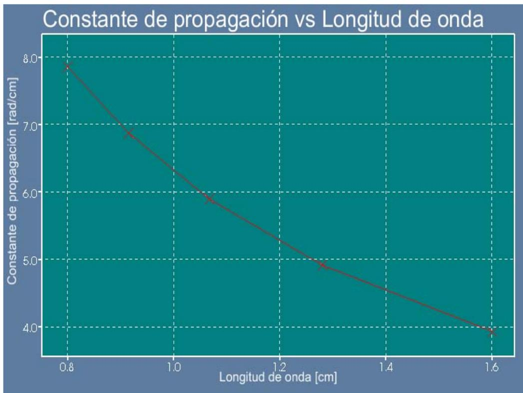
**Figura 5.3** Constante de propagación en función de la longitud de onda calculada con el programa
