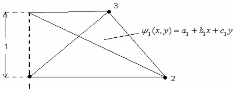
Figura 3.2. Función de forma  $\Psi_1$  correspondiente al nodo 1 en un elemento triangular de primer orden en el plano x-y. las funciones  $\Psi_2$  y  $\Psi_3$  se obtienen de forma similar.
