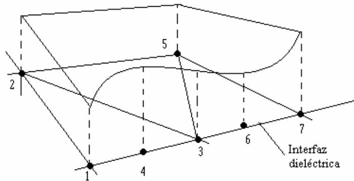
Figura 3.4 Funciones de interpolación de orden mezclado en elementos adyacentes a una interfaz dieléctrica
