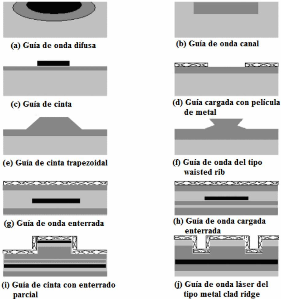
**Figura 1.1. Secciones transversales de algunos tipos de guías de onda ópticas**
