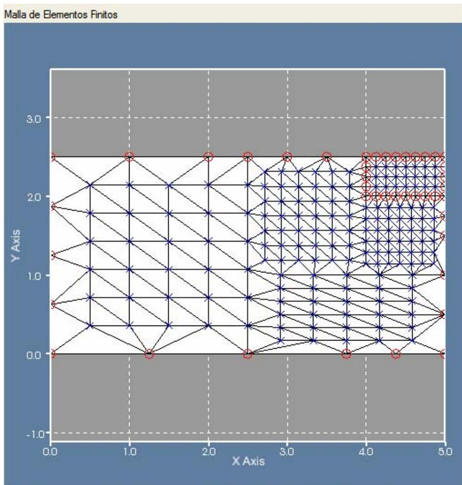
**Fig. 4.6. Construcción de la malla de elementos finitos triangulares**
