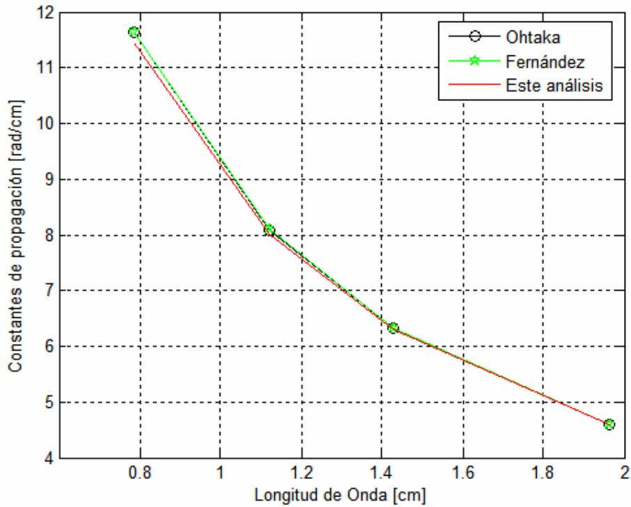
**Figura 5.7. Dispersión del modo Ey11 en una guía de onda enterrada**
