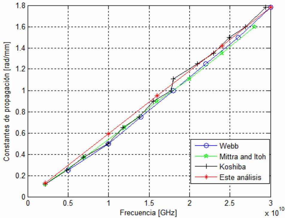
**Figura 5.11 Características de propagación del primer modo línea de transmisión del tipo microstrip con un sustrato anisotrópico.**
