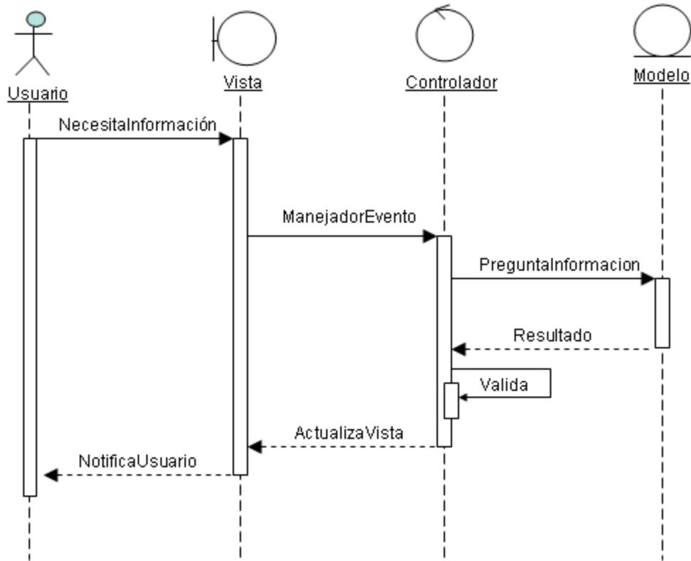
Fig. 3.10 Modelo Vista Controlador (MVC)
