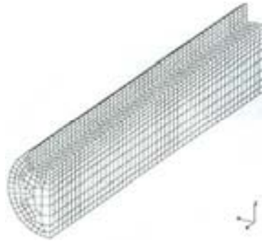
Figura 4.25. Modelado de 1/4 de la pieza mediante elemento finito [21].
