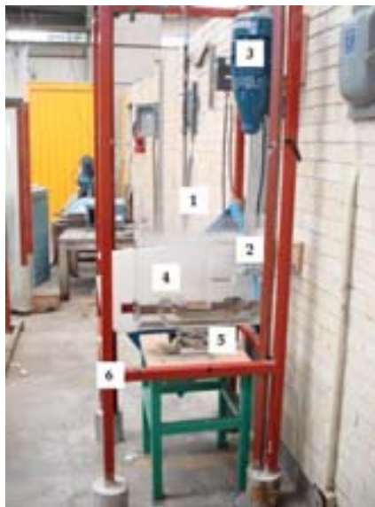
Figura 3.1. Modelo físico de tanque de temple y equipo complementario empleado en esta investigación. (1) Modelo físico, (2) propela, (3) motor de la propela, (4) juego de persianas, (5) gato y (6) estructura metálica [15].
