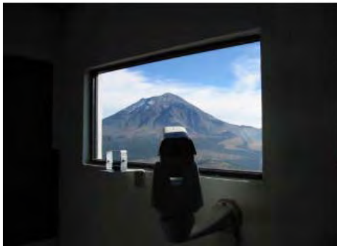
Figura 2. a) Cámara de video-vigilancia instalada en el Cerro de Tlamacas. b) Cámara térmica instalada en el cerro de Altzomoni. Tomado de Guevara Ortiz et al, 2003.
