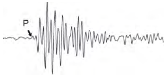
Figura 9. Sismo de periodo largo registrado en el volcán Kilauea, Hawái. Tomado de Kumagai et al., 2005.
