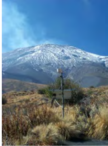
Figura 6. Detector acústico de flujos en la barranca La Espinera. Tomado de Guevara-Ortiz et al, 2003.
