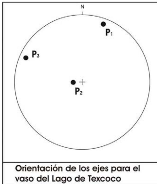
Figura 5.3 RESULTADOS DE LA INVERSION del campo de esfuerzos representadas mediante dos proyecciones estereográficas de Lambert para las zonas de Centro – Poniente del Distrito Federal (arriba) y para Texcoco. P<sub>1</sub>, P<sub>2</sub> y P<sub>3</sub> tienen el mismo significado que en la figura 5.2.
