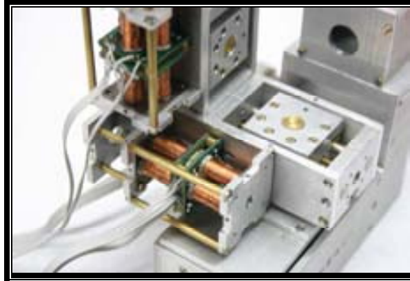
Figura 5-15 Motores alojados en las transmisiones de la micromáquina herramienta.
