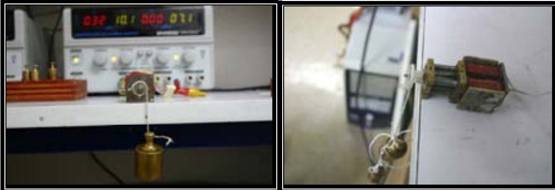
Figura 5-4 Forma en como fue desarrollada la prueba de par en ambos motores.
