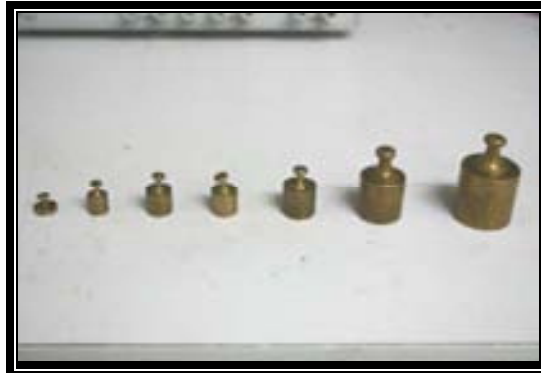
Figura 5-3 Pesos patrón con los cuales se realizaron las mediciones de par.
