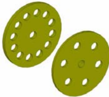
Figura 4-3 Incrementando el número de imanes en el rotor iniciando con un número de 6 imanes.
