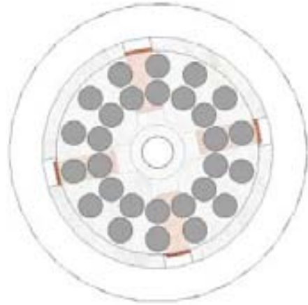
Figura 5-14 Forma de los imanes del rotor de fuerza de Lorentz.
