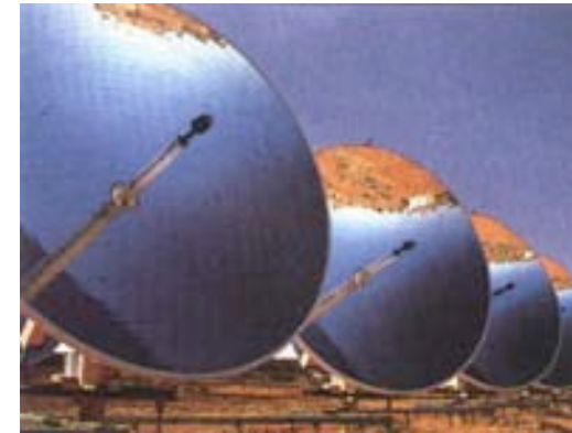
3.116 Concentradores solares, de plato parabólico.
