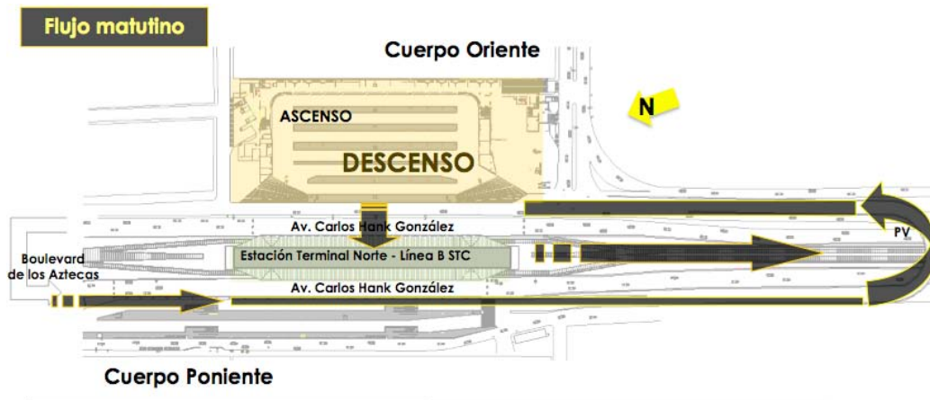
Figura 4.5 Flujo matutino durante la segunda etapa de construcción.
