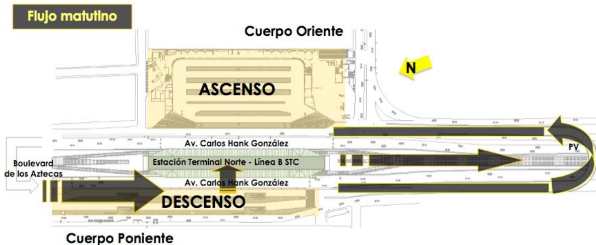
Figura 3.12 Esquema del recorrido de los flujos matutinos en los cuerpos de operación
