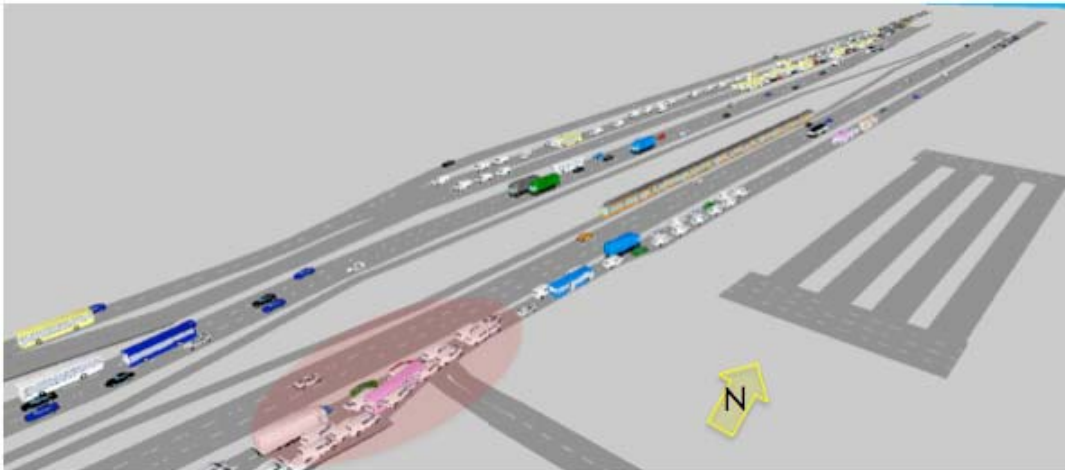
Figura 4.4 Imagen de la simulación de la situación esperada durante el proceso de construcción de la ETRAM. En rojo, problemas viales sobre la lateral.
