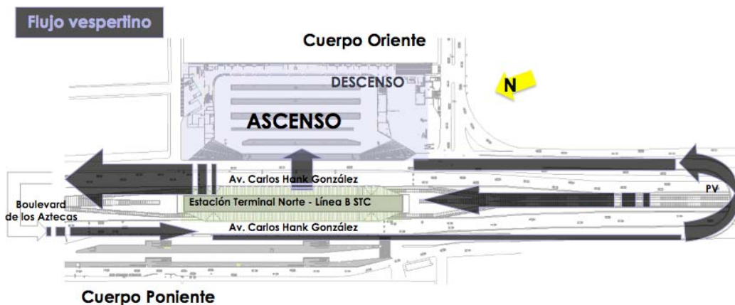
Figura 4.6 Flujo vespertino durante la segunda etapa de construcción.
