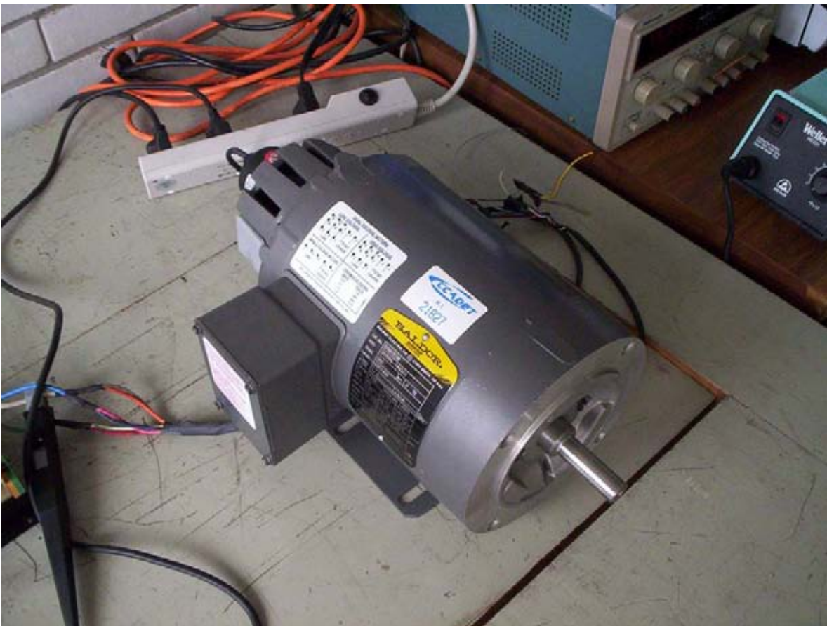
Figura 3.47. Motor trifásico de 1/2 Hp., empleado como carga para las pruebas realizadas sobre el sistema implementado.
