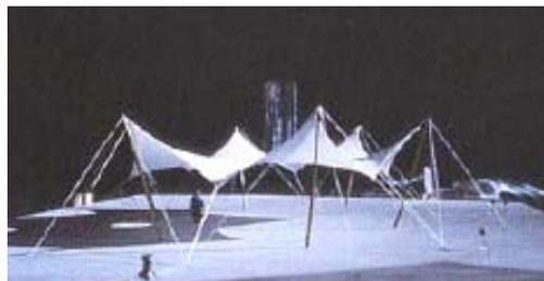
**Figura 2.17. Modelo para red de cables, con diversos puntos altos**
