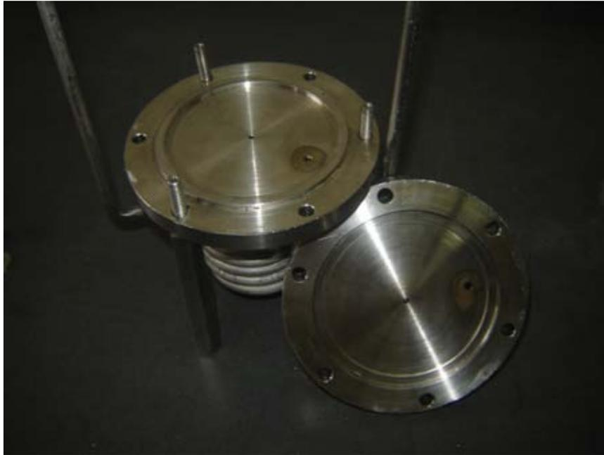
**Figura 7. Parte interior de la celda de transmisión de gas.**
