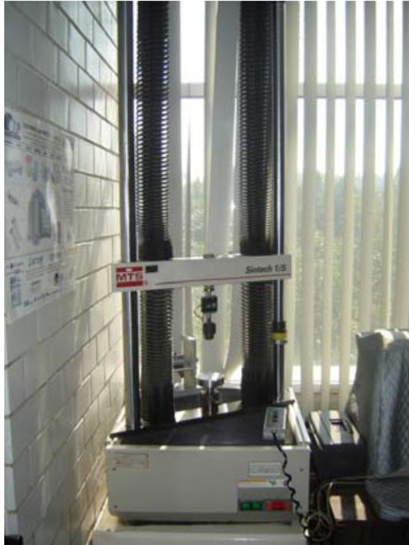
**Figura 4: Maquina de pruebas mecánicas Sintech 1/s**
