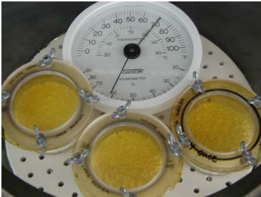
**Figura 5. Celdas para determinar la PVA.**
