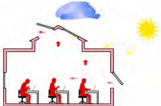
*Imagen 11. Esquema de funcionamiento del efecto chimenea. Fuente: Window Master*
