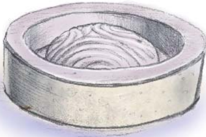
Molde maestro realizado en silicón para obtener series de moldes perdidos
