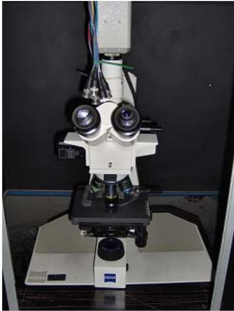
**Figura 19** Microscopio de fluorescencia
