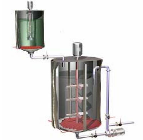
Figura 23 Tanque de modificación con sistema de recirculación y tanque de alimentación de agentes estabilizadores.
