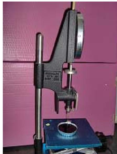
**Figura 17** Penetrómetro y muestra de AM
