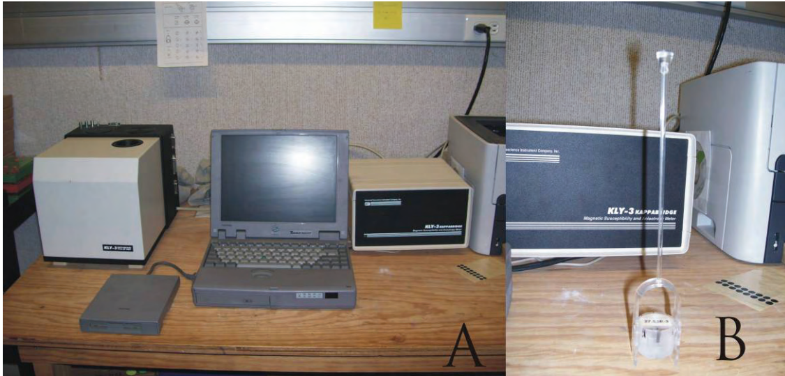
Fig. 37. En la fotografía (A) se muestra el instrumento KLY-3 Kappabridge “Magnetic Susceptibility and Anisotropy Meter” ; de izquierda a derecha se observa la unidad de soporte (donde se colocan los especímenes, pick-up unit ), la computadora que procesa los datos, y la una unidad de control ( control unit ). La fotografía (B) muestra el porta-muestras, donde se coloca cada uno de los especímenes para introducirlos a la unidad de soporte y medir su susceptibilidad magnética en 15 posiciones diferentes.
