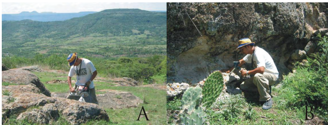
Fig. 35. (A) Obtención de núcleos en un afloramiento de la ignimbrita Alacrán. (B) El núcleo se orienta cuando todavía esta adherido al afloramiento. Se obtienen el azimut y buzamiento de su eje principal, así como su azimuth solar cuando es posible.
