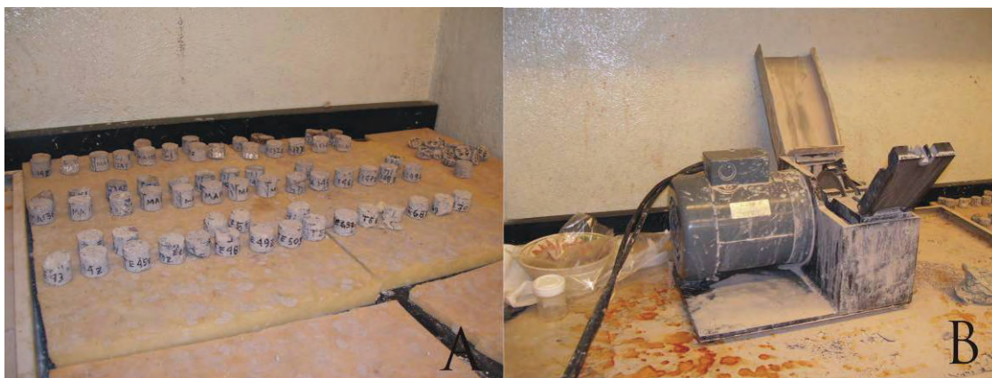
Fig. 36. En la foto (A) se muestran los especímenes ya cortados con un espesor de 2.5 cm; en la foto (B) se muestra la cortadora de núcleos.
