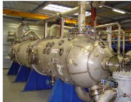
Fig. 2.49. Diseño de un separador submarino (izquierda), separador submarino de prueba en tamaño real (derecha).
