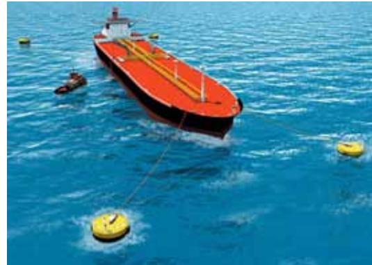
Fig.3.76. Sistema convencional de boya (CBM).
