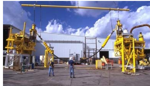
Fig. 2.106. Prueba de jumper flexible y su conexión con arboles submarinos.
