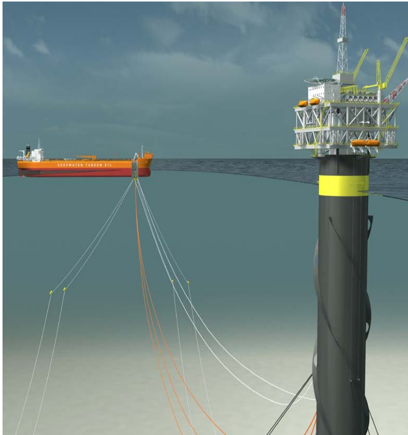
Fig.3.70. Transferencia tandem por manguera sumergida.
