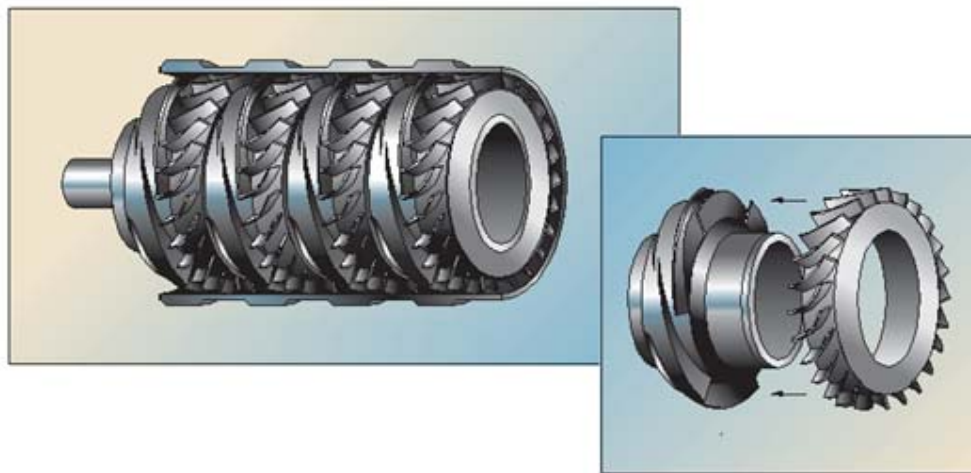
Fig. 2.34. Sistema helicoaxial de cuatro etapas de una bomba multifásica.
