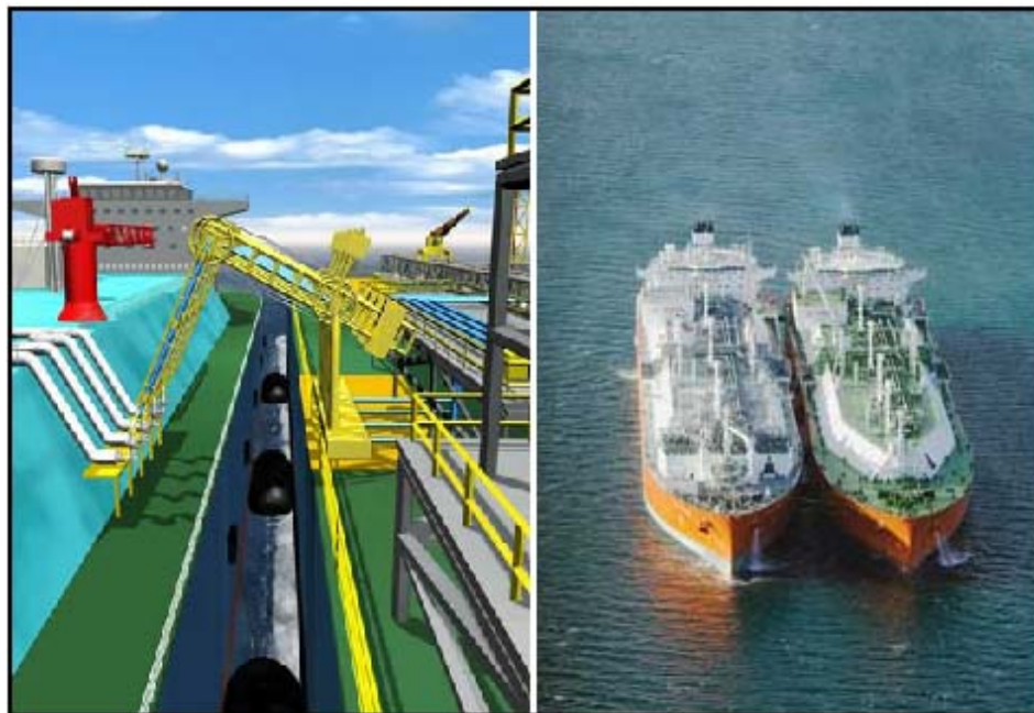
Fig.3.67. Transferencia de costado.
