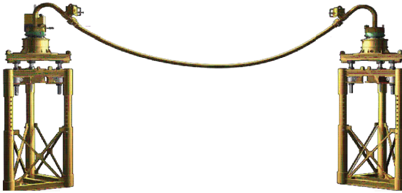
Fig. 2.24. Jumper flexible con conexión inclinada.
