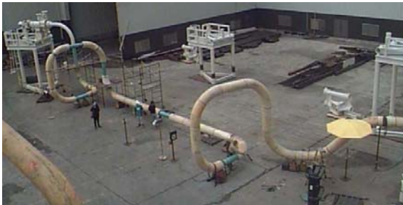
Fig. 2.105. Prueba del jumper rígido.
