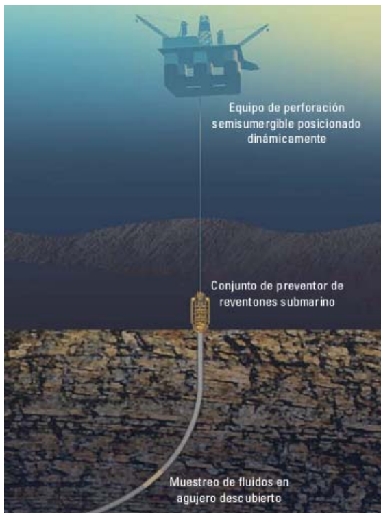
Fig. 1.26. Muestreo de fluidos en agujero descubierto.
