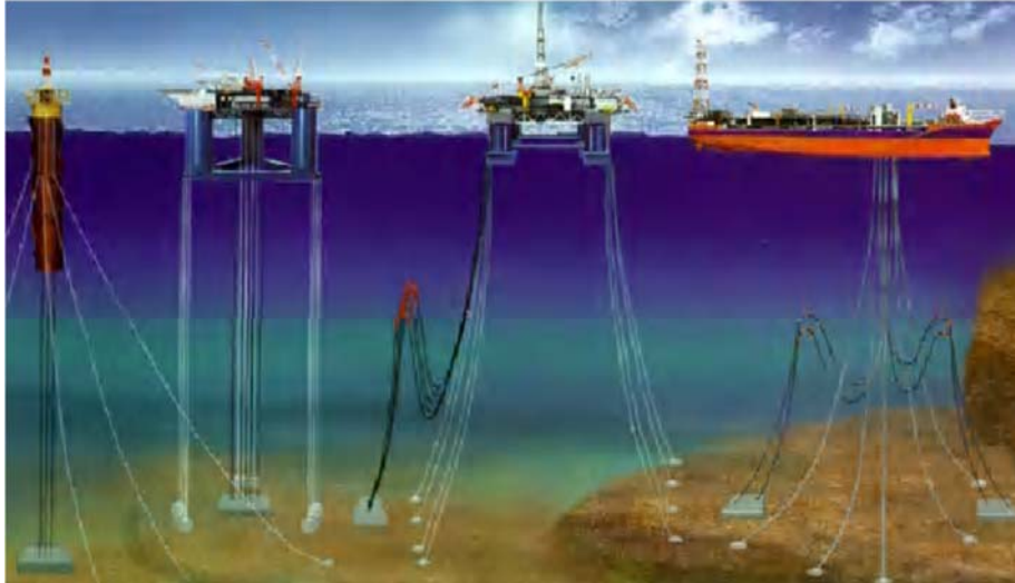
Fig. 2.92. Anclaje de equipos flotantes.
