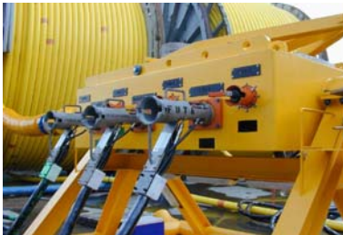
Fig. 2.63. Conjuntos de terminación umbilical UTA por su nombre en inglés "Umbilical Termination Assembly".
