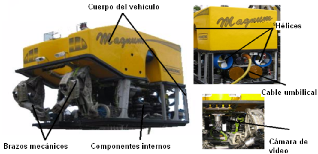
Fig. 2.26. Principales componentes del ROV.
