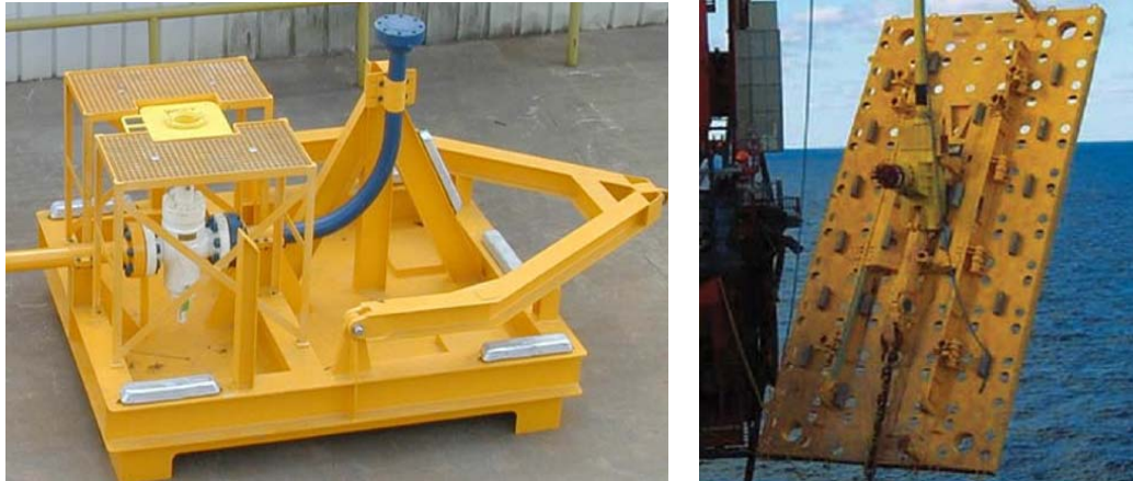
Fig. 2.20. PLEM, Pipe line end manifold (izquierda) y PLET pipe line end termination (derecha).
