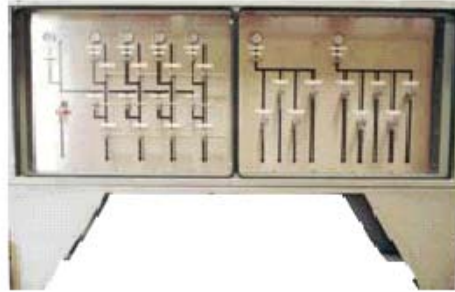
Fig. 2.58. Unidad de inyección de químicos
