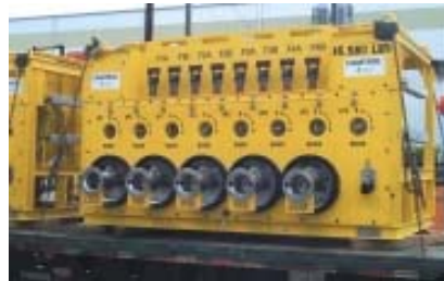
Fig. 2.63. Conjuntos de terminación umbilical UTA por su nombre en inglés "Umbilical Termination Assembly".
