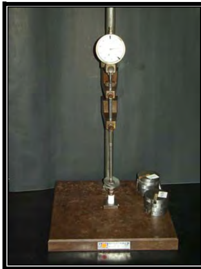
Figura 11. Aparato de medición de deformación en tensión
