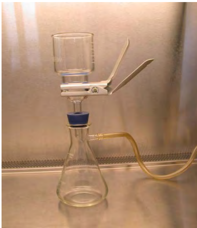
Fig.5 Sistema de filtro
