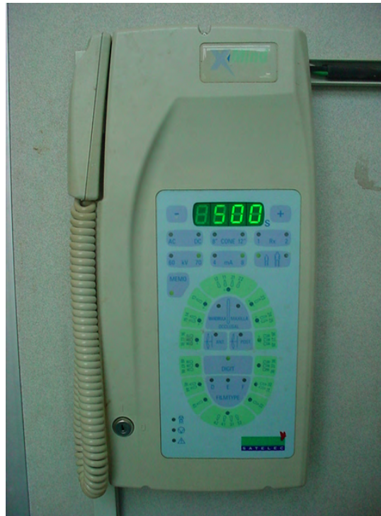
fig.17 Dispositivo controlador de radiación 1
