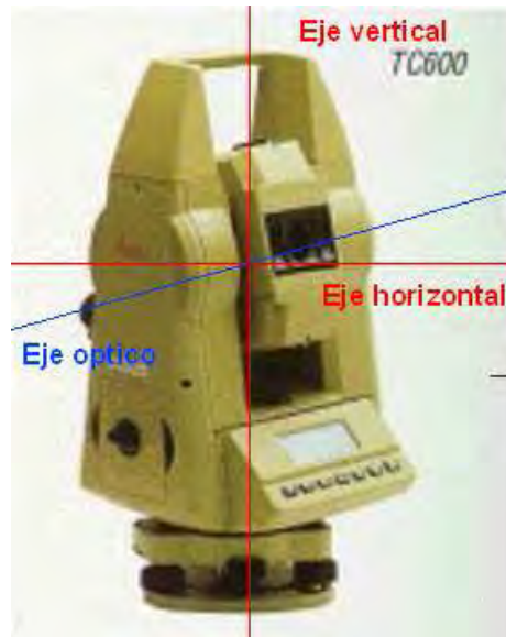
Figura 2.2.1 Diagrama de ejes principales de la Estación total
