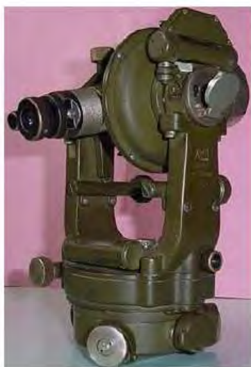
Figura 2.1.5 Teodolito Kern DK-2 son sistema de lectura de coincidencia
