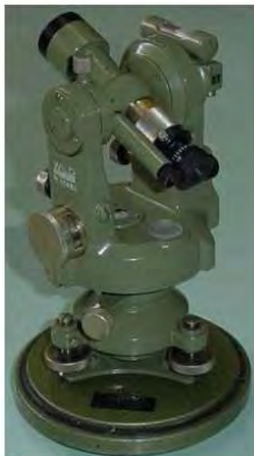
Figura 2.1.4 Teodolito Brújula Wild T0 con micrómetro óptico
