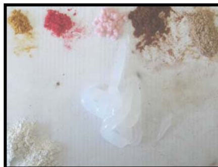
Figura 19.Fibras flock, caolín y silicón grado médico
