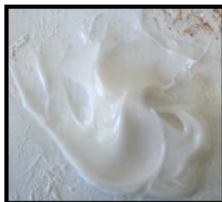
Figura.20 opacidad, resultado de la adición de caolín.
